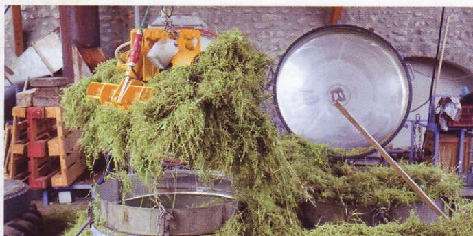
Lavendel wird in einen industriellen Kocher geladen. Das Öl wird danach durch Wasserdampfdestillation gewonnen.
